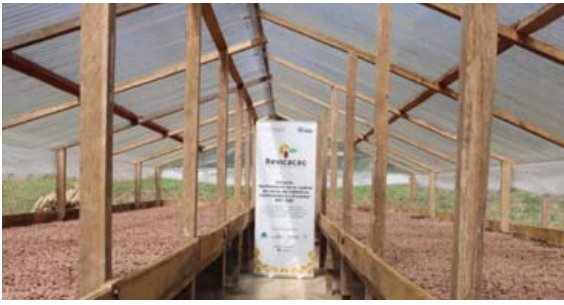
Secador solar en ASODIRP, con 2 camas de secado con capacidad de 50 quintales de cacao seco. El secador ya está en uso.
