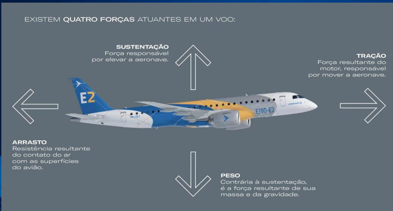
O avião voa por causa do **formato das asas** e de outras partes, como **turbinas e pás**, que geram impulsos. Além disso, **os caminhos que o ar percorre** por todo o comprimento do avião geram **diferenças de pressão** que permitem o vôo.
