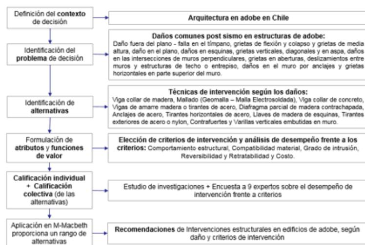
Figura 16: Estructura del análisis multicriterio y aplicación en edificios de adobe en Chile.
