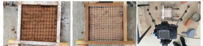
Figura 19: Ejemplos de especímenes preparados para la aplicación del mortero y ejecución de mediciones con DIC
